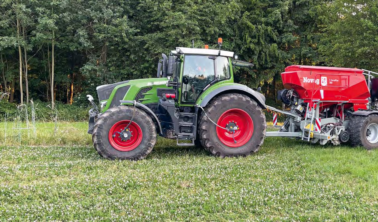
Direktsaatmaschine Novag T-Force plus 350 mit 3 m Arbeitsbreite mit Cross-Slot-Scharsystem.
