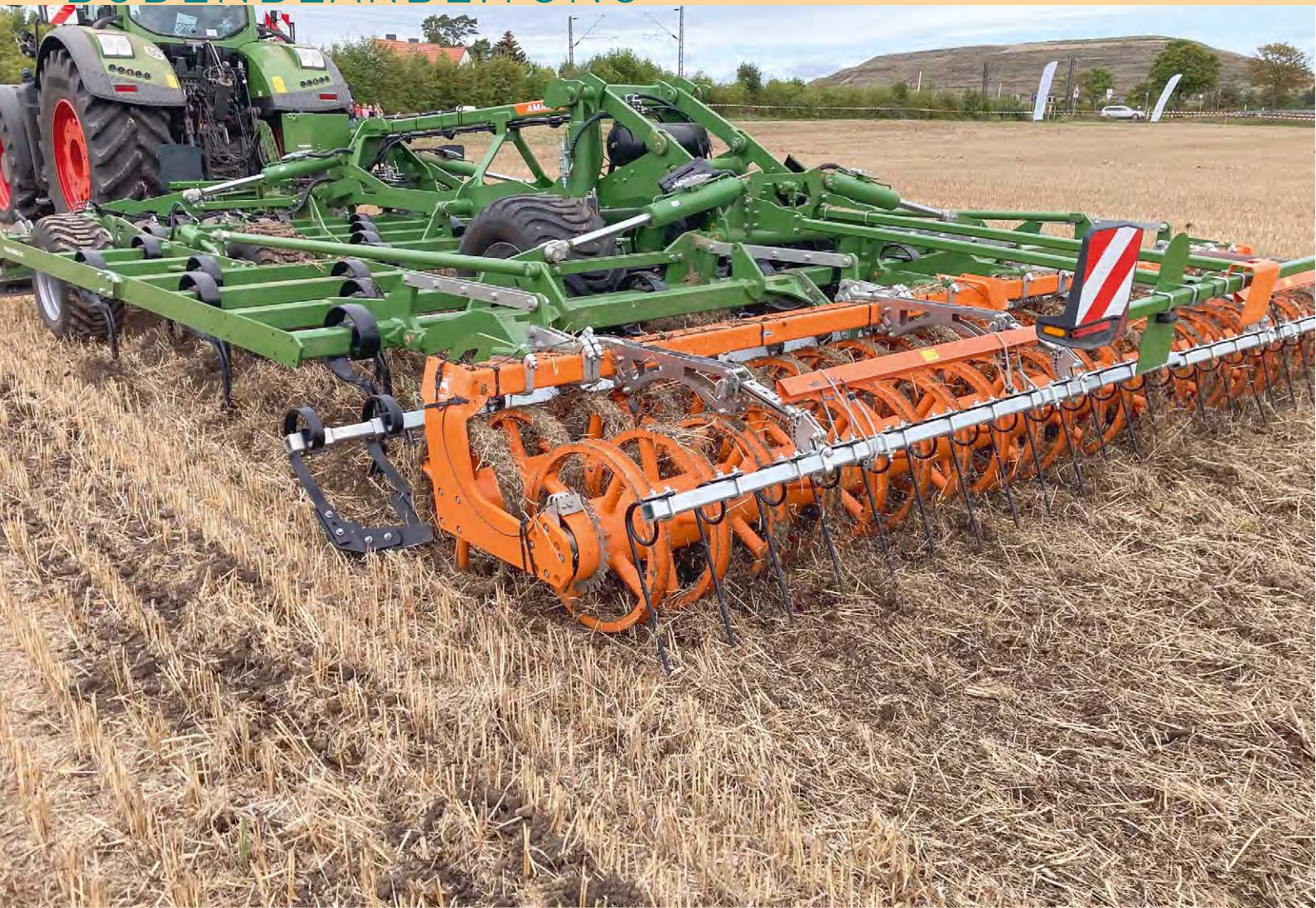
Ultraflache Stoppelbearbeitung mit dem Flachgrubber Amazone Cobra 6000-2TX.
